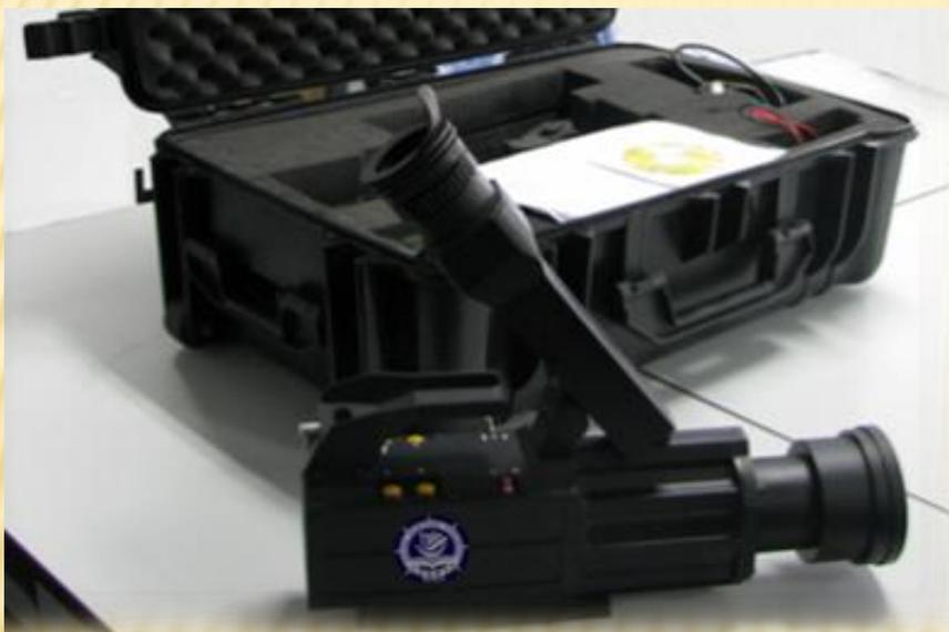
CCD远红外溢油监测设备
